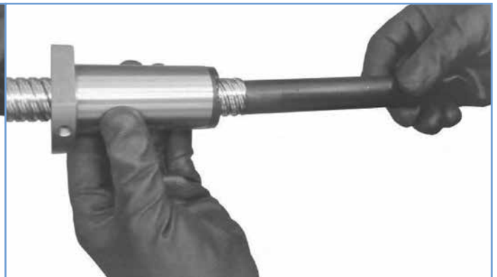
CON LA CHIOCCIOLA INTERAMENTE MONTATA SULLA VITE, TOGLIERE LA FALSA GUIDA
